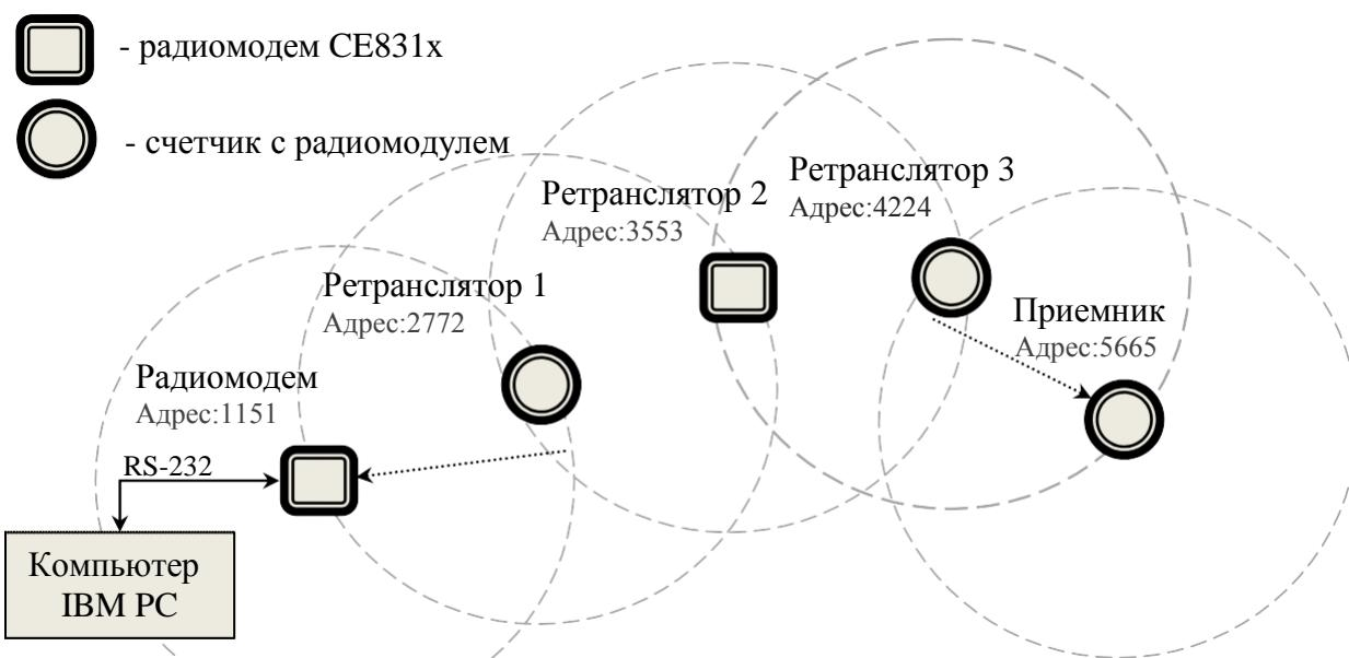
Рисунок 5.17 - Пример схемы ретрансляции.
