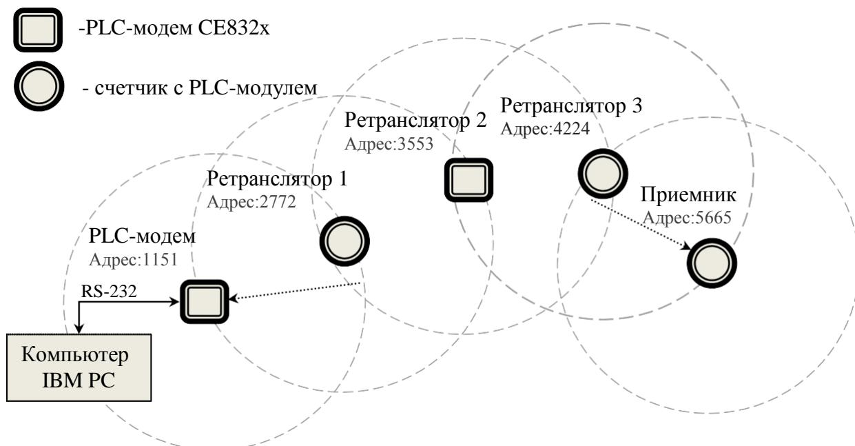
Рисунок 5.24 - Пример схемы ретрансляции.
