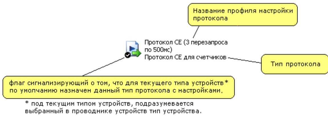
Рисунок 2.18 - Внешний вид пиктограммы профиля настройки протокола.
