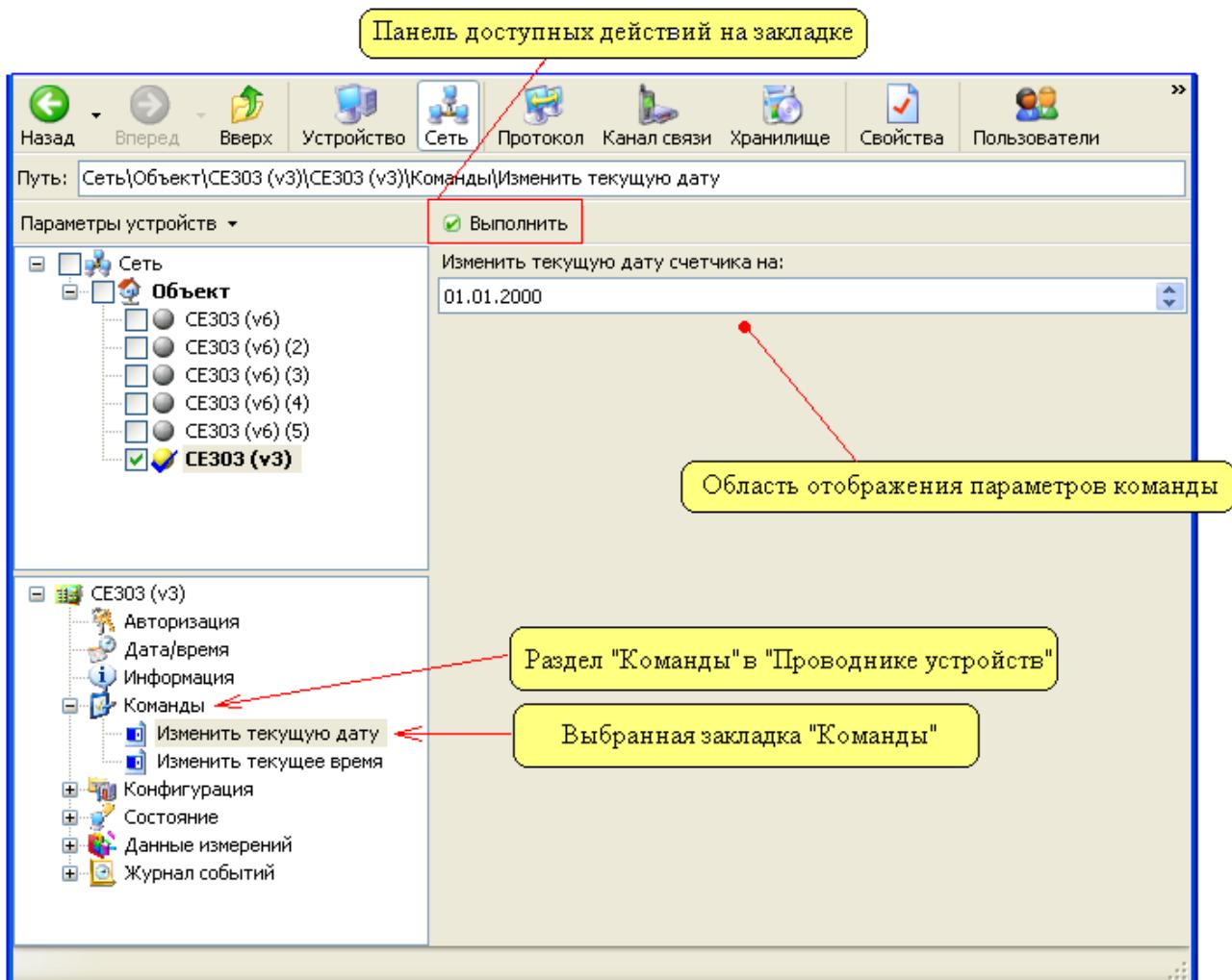
Рисунок 4.3 - Пример внешнего вида закладки типа «Команды».
