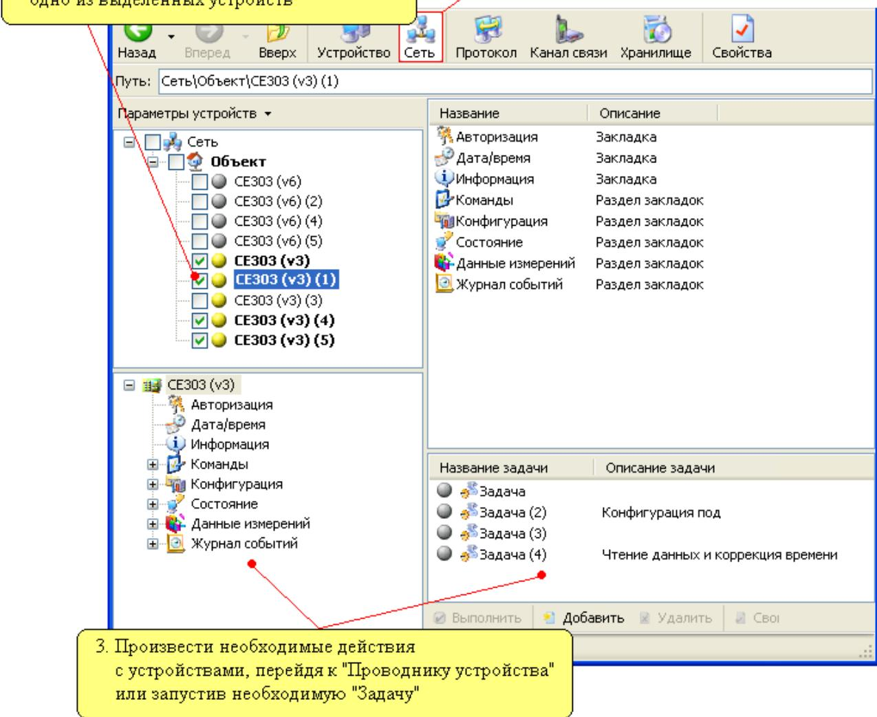
Рисунок 3.11 - Последовательность действий для начала работы в «Групповом режиме».
