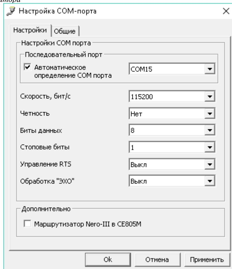
Рисунок 5.6 - Внешний вид окна настроек канал связи типа «RS-232».
