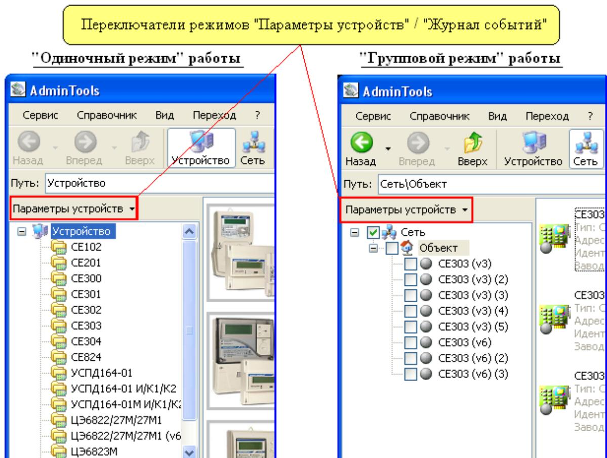
Рисунок 2.31 - Переключатель для просмотра «Журнала событий» или «Параметров устройств». В «Одиночном режиме» и «Групповом режиме» работы.
