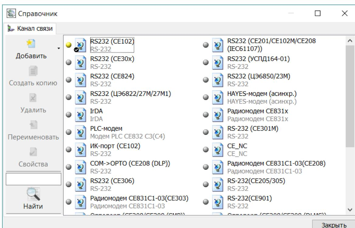
Рисунок 5 - Внешний вид справочника настроек каналов связи.
