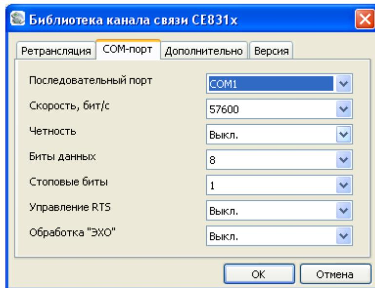
Рисунок 5.14 - Внешний вид окна «Библиотека канала связи Радиомодем CE831». Вкладка «СОМ-порт».
