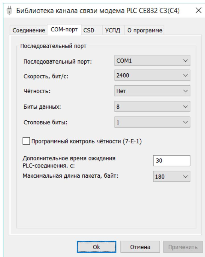
Рисунок 5.27 - Внешний вид вкладки «СОМ-порт».
