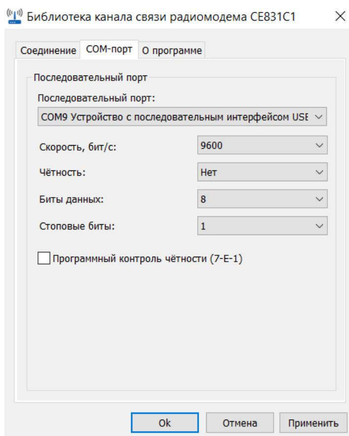
Рисунок 5.37- вкладка СОМ-порта канала связи радиомодема
