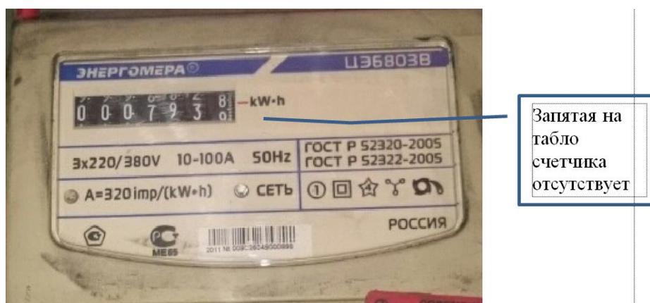
Рисунок 2 – На табло счетчика 7938 кВт\*ч.
