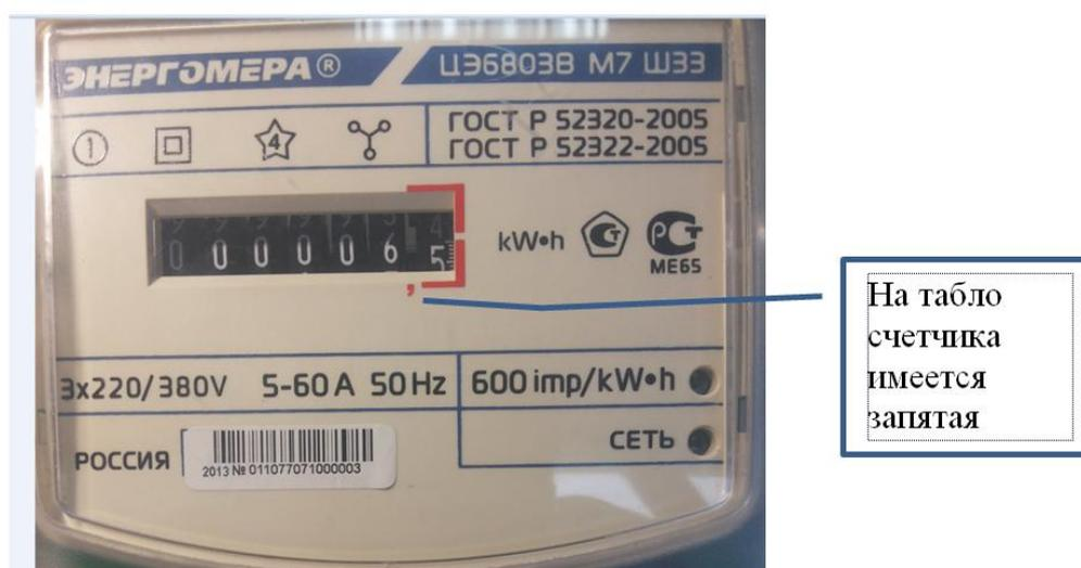
Рисунок 1 – На табло счетчика 6,5 кВт\*ч.
