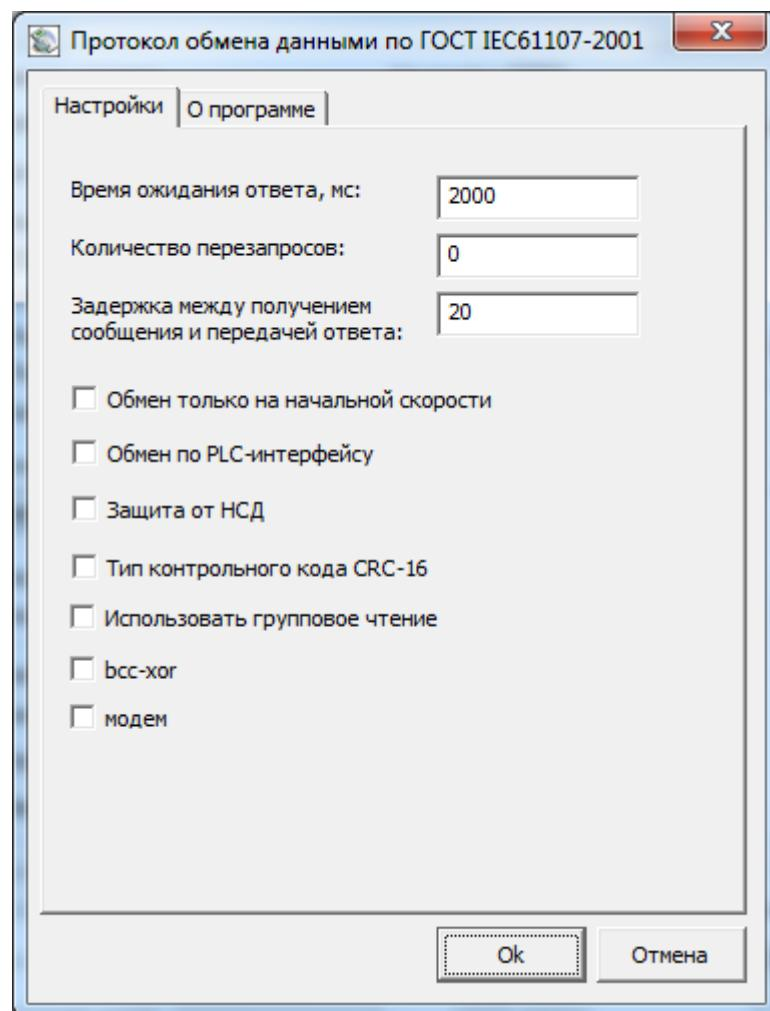
Рисунок 15 – Настройки по протоколу ГОСТ IEC61107-2001
