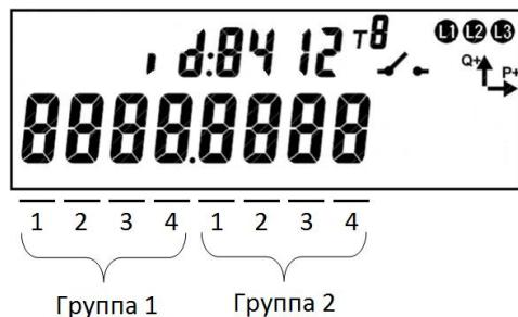
Рисунок 22 – Отображение параметров GSM-модуля
