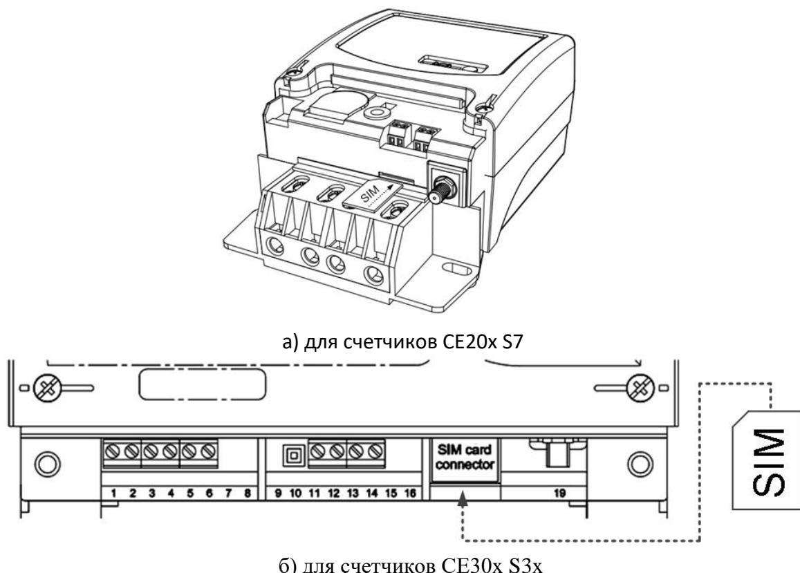
Рисунок 1 – Внешний вид счетчика с местом установки SIM – карты.
