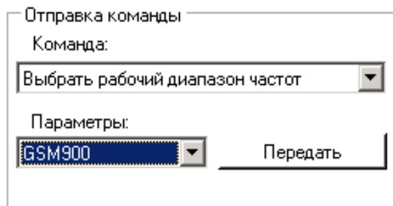
Рисунок 19 – Команда выбора рабочего диапазона частот
