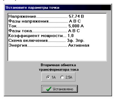
Установите на установке ЦУ6800 указанные в окне параметры, а переключателями "Предел по току образцового счетчика" или "Вторичная обмотка трансформатора тока" выберите предел, соответствующий пределу по току. Нажмите кнопку "Установлено".
