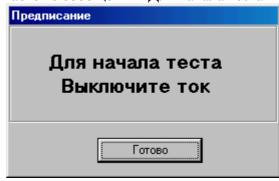
При этом ток на установке ЦУ6800 необходимо выключить и затем нажать кнопку "Готово". В появившемся окне "Показания" необходимо заполнить поля показаниями счетных устройств соответствующих счетчиков в кВт•час. Нажать кнопку "Готово".
