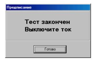
3.5.3.25 После завершения теста необходимо вручную установить результат проверки, для этого щелкните правой кнопкой мыши на соответствующем поле и выберите нужный результат (сравнивая показания на табло и на счетных устройствах счетчиков).
