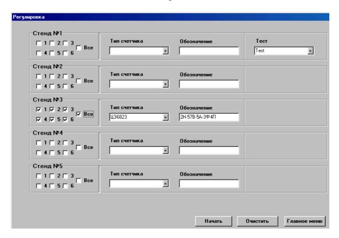
3.5.2.5 Для запуска измерения погрешности, после заполнения всех полей, щелкните по кнопке "**Начать**". При этом появится окно "Таблица проведения теста". В таблицу внесены точки, выбранные из тестовой таблицы, указанной в поле "Тест" предыдущего окна.
