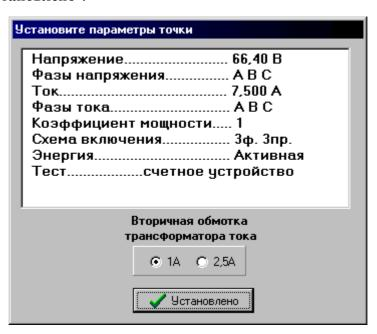
При этом появится окно "Поверка", а на табло - значения энергий, соответствующие значению на счетных устройствах счетчиков. По мере прохождения теста, значения на табло будут увеличиваться (при исправном счетном устройстве синхронно с показаниями счетчиков).
