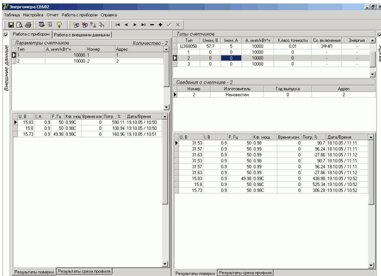
В основном поле могут быть развернуты панели «Внешние данные» и «Архив» с таблицами параметров счетчиков и результатов измерений.
