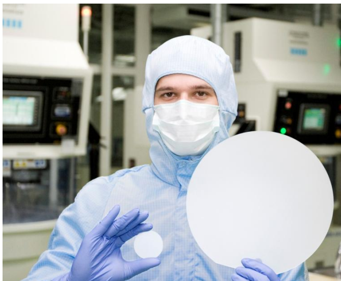
10-дюймовая пластина сапфира в сравнении с 2-дюймовой
