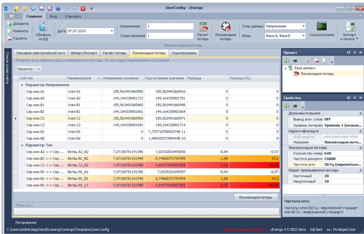
Для старта процедура расчёта необходимо в панели меню указать дату, на которую в базе имеются измеренные мгновенные значения токов и напряжений по счётчикам узлов сети, после чего нажать на кнопку «Локализация потерь».
