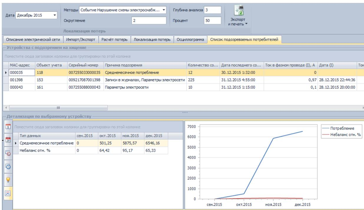
Для просмотра списка устройств с подозрением на хищение следует выбрать события, на основе которых производится анализ хищения, месяц и группу узлов учета (анализ производится только для счетчиков CE208 SMP).
