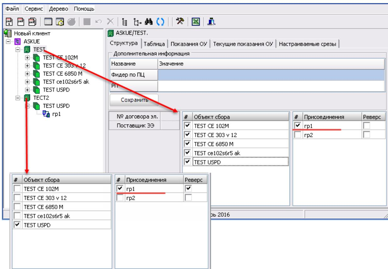
Т.к. в присоединение «гр1» включены два счетчика с серийными номерами 00221 и 00112, то данные счетчики в сEnergo добавятся в балансную группу «TEST USPD (1,1)» без реверса и в балансную группу «TEST USPD (1,2)» с реверсом.
